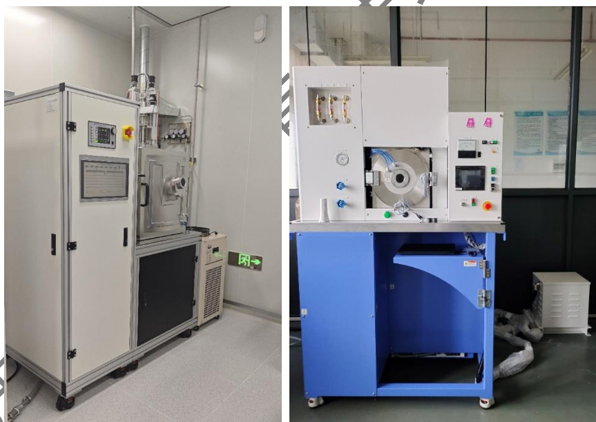
图 2 放电等离子烧结炉与高真空电子束蒸发镀膜系统
